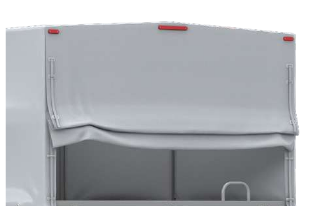
Контурные огни и дополнительный сигнал торможения (для широкой платформы)
