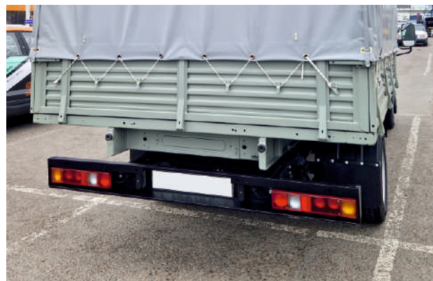
Задняя балка с интегрированной светотехникой и штатными местами под датчики парковки и камеру (зависит от модификации)
